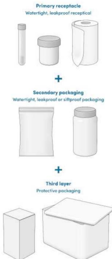
Figura 3. Sistema básico de embalaje/ensado triple. Ilustración creada para la 4ª edición del Manual de Bioseguridad en el Laboratorio de la WHO
